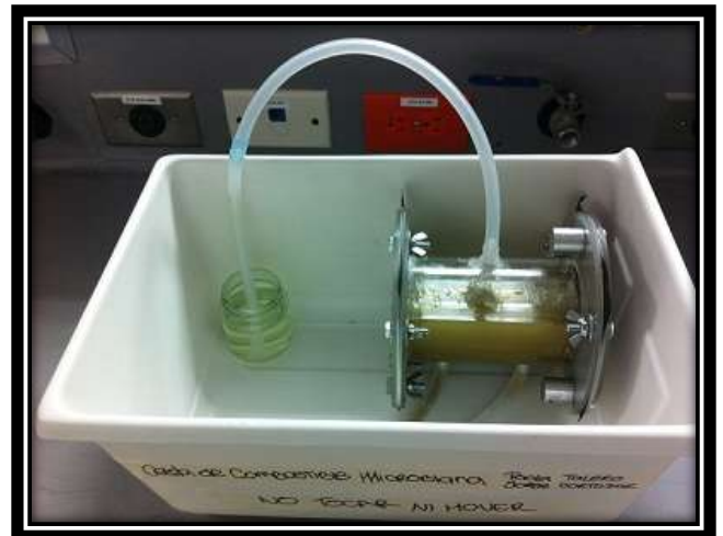
Figura 11. Montaje inicial de la Celda de Combustible Microbiana con heces de cerdo
