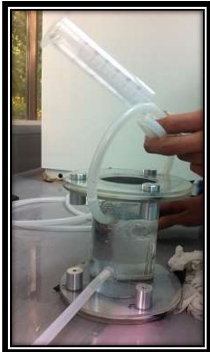
Figura 10. Prueba de fugas previa al montaje
