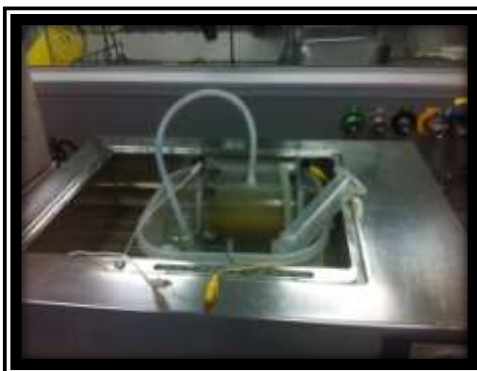
Figura 16. Celda de Combustible Microbiana con heces de cerdo.
