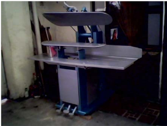
Imagen No. 18: Plancha industrial con sistema de pedal para inyección de vapor y seguro de presión (requiere ducto de suministro de agua).
