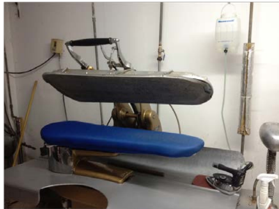
Imagen No. 19: Detalle plancha industrial con cojinete y funda protectora, junto con plancha convencional para detallado de prendas.
