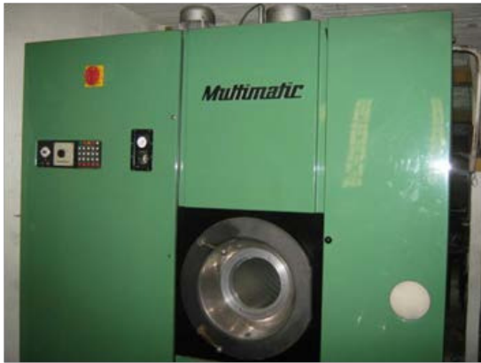
Imagen No. 16: Lavadora industrial de lavado en seco, acceso frontal, control digital de tiempos y ciclos, con control de presión y temperatura.
