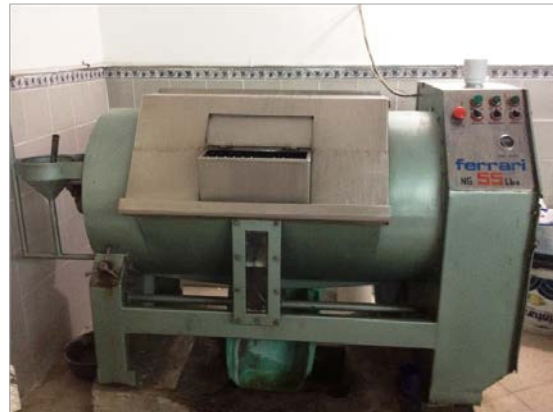
Imagen No. 15: Lavadora industrial de tambor, ideal para manejo de prendas con malla, bajo sistema de agua (prendas finas).
