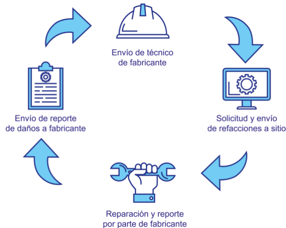
Figura 5. Ciclo actual de reparación de equipos en buques
