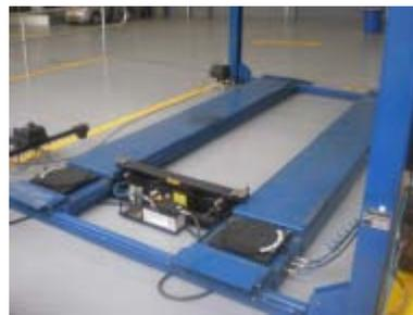
**EQUIPO DE ALINEACION**, con 6 sensores, medición TRIDIMENSIONAL, modelo GEOLINER 460, ref. EEWA710A, marca **HOFMANN**, completo con mueble, PC, monitor de 15", ratón, teclado, cables de conexión a consola, software actualizable, con las siguientes características técnicas:
