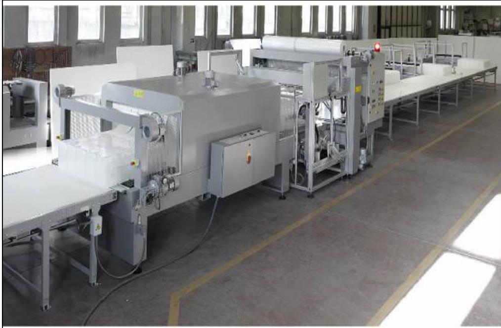
Figura 9. Máquina empacadora de polietileno Fuente Proveedor: Office Meccaniche Pontida
