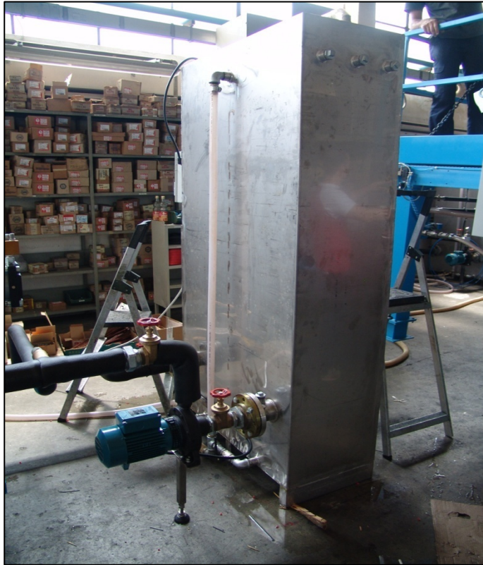
Figura 11. Intercambiador de Calor Fuente Proveedor: Office Meccaniche Pontida
