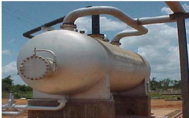
Figura 59. Fotografía de un separador horizontal de líquido-gas.
