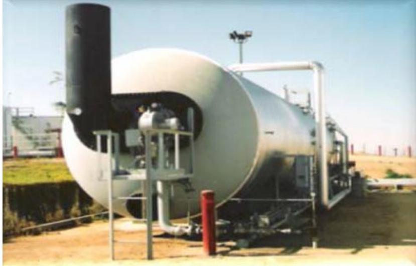
Figura 60. Tratador Térmico Horizontal. Tomado de <http://www.oiltraters.com/>
