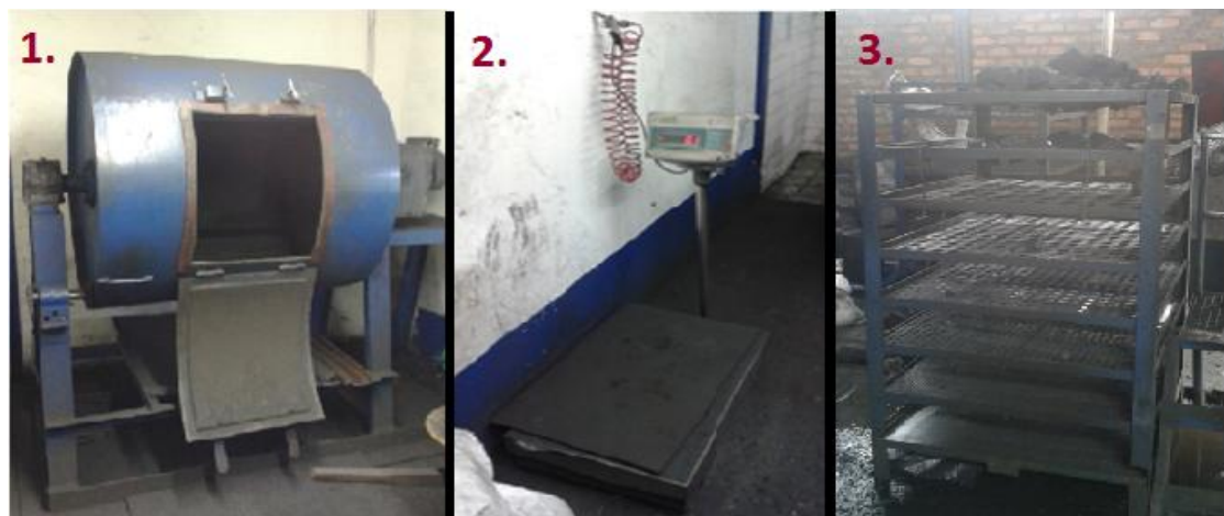
Figura 30. Equipos Para Pruebas Físicas de Coque (1. Tambor Rotatorio; 2. Báscula; 3. Tamiz)
