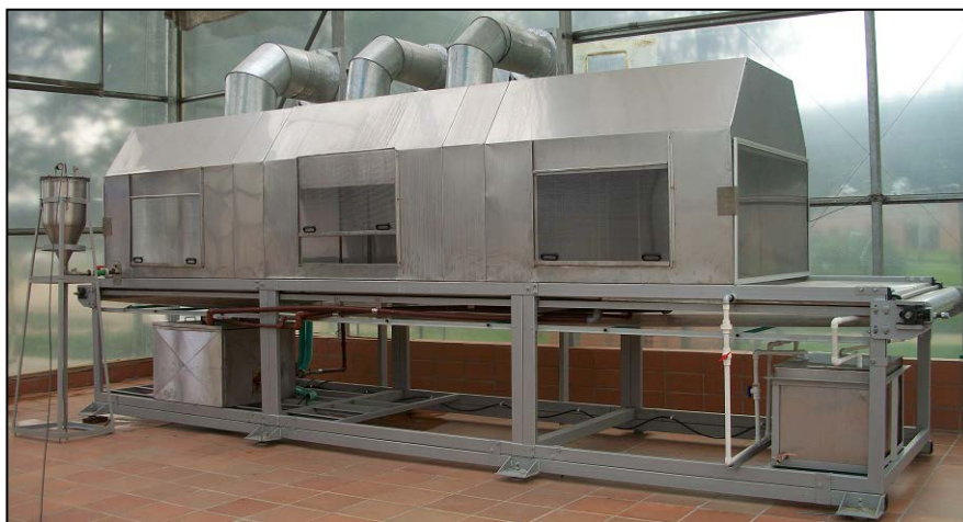
Figura 2. Equipo piloto de secado por radiación infrarroja, ubicado en el Biocentro
