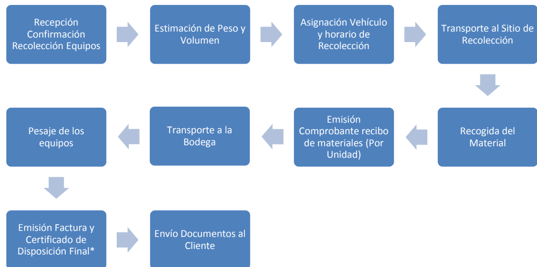
Figura 11. Diagrama del Proceso de Recolección
