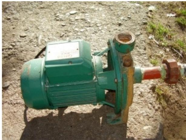
Figura.7. Bomba de agua utilizada en el proceso. Fuente: Investigador 2012.
