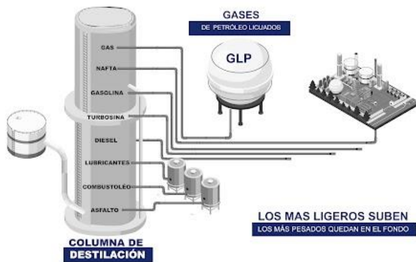
Figura 2. Torre de destilación. Análisis Operacional de Depósitos de Hidrocarburos Refinados. (González, 2017)
