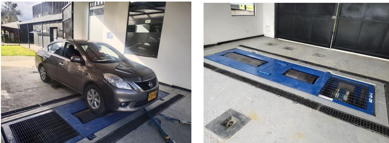
Figura 4.14. Izquierda: Vehículo experimental durante una prueba dinámica. Derecha: Dinamómetro de chasis Mustang Dyno MD-110SE
