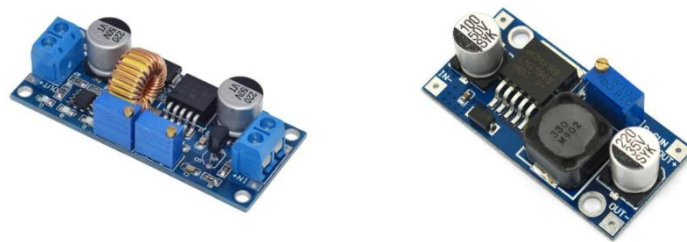
Figura 4.5. Convertidores DC-DC BUCK XL4015 y BUCK LM2596
