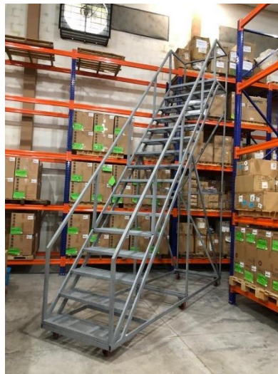
Ilustración 11. Escalera Tipo Avión
