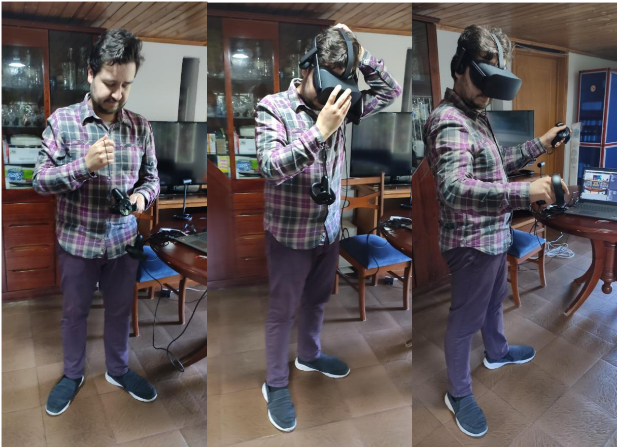
Figura 11.5 Proceso de ponerse el HMD para su uso. La persona primero se asegura los controles en las muñecas, luego se pone el casco y ejecuta la herramienta de entrenamiento.
