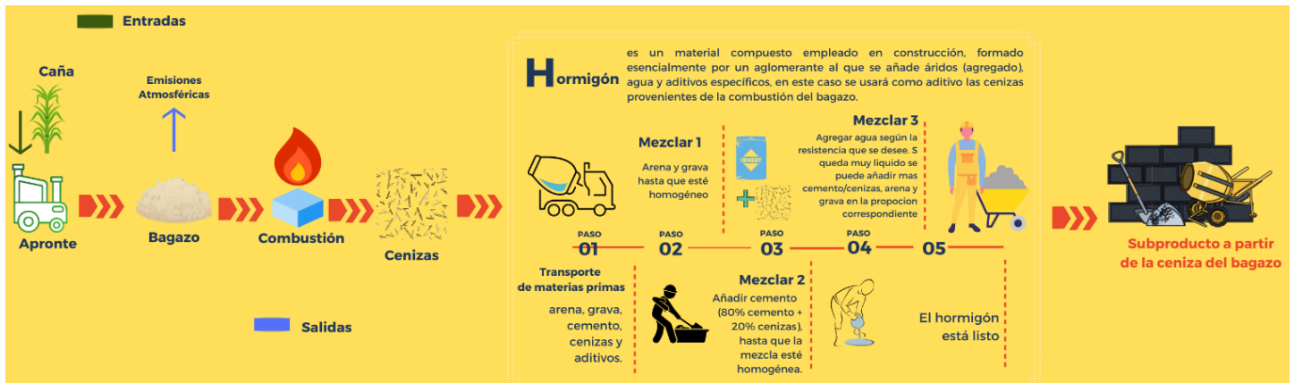
Figura 176. Definición del proceso productivo total del Hormigón. Fuente: Propiedad del autor.
