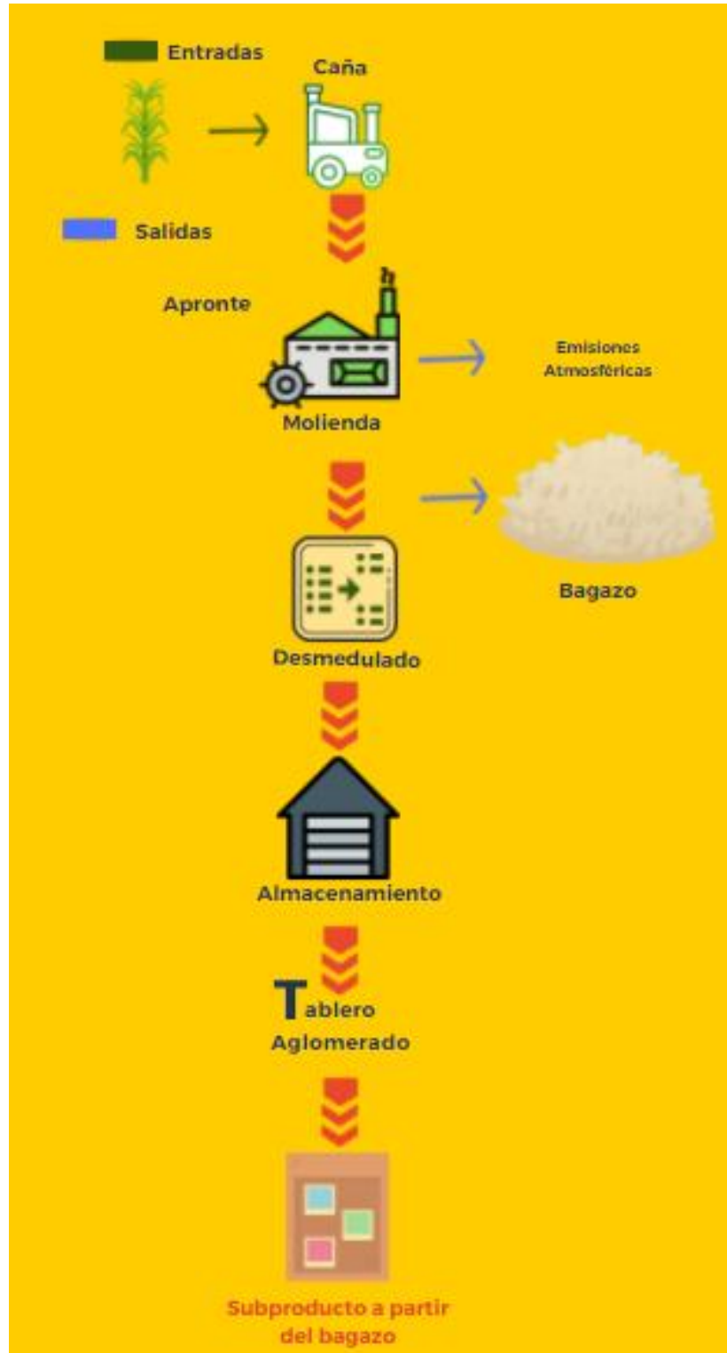
Figura 215. Definición del proceso productivo total del Tablero Aglomerado. Fuente: Propiedad del autor.
