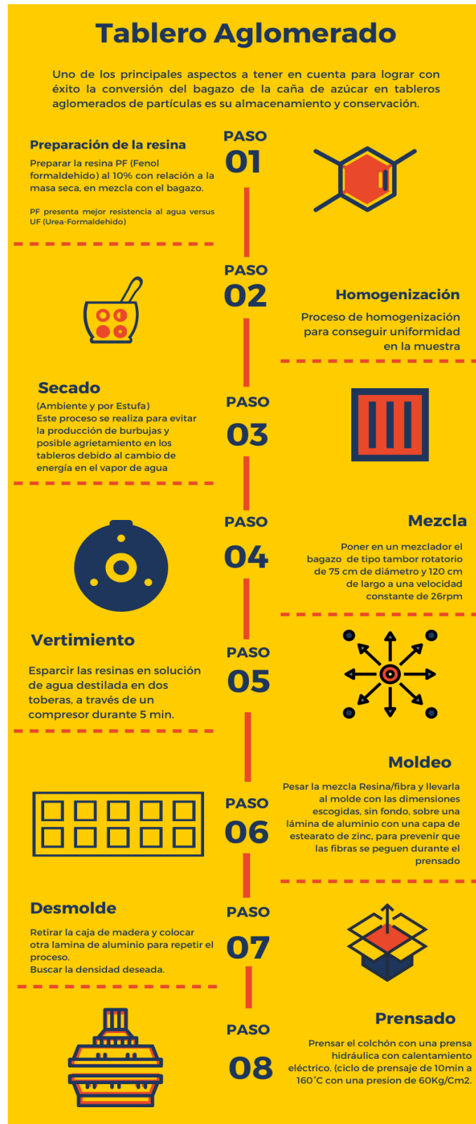
Figura 62. Definición del proceso del Tablero Aglomerado. Fuente: Propiedad del autor.
