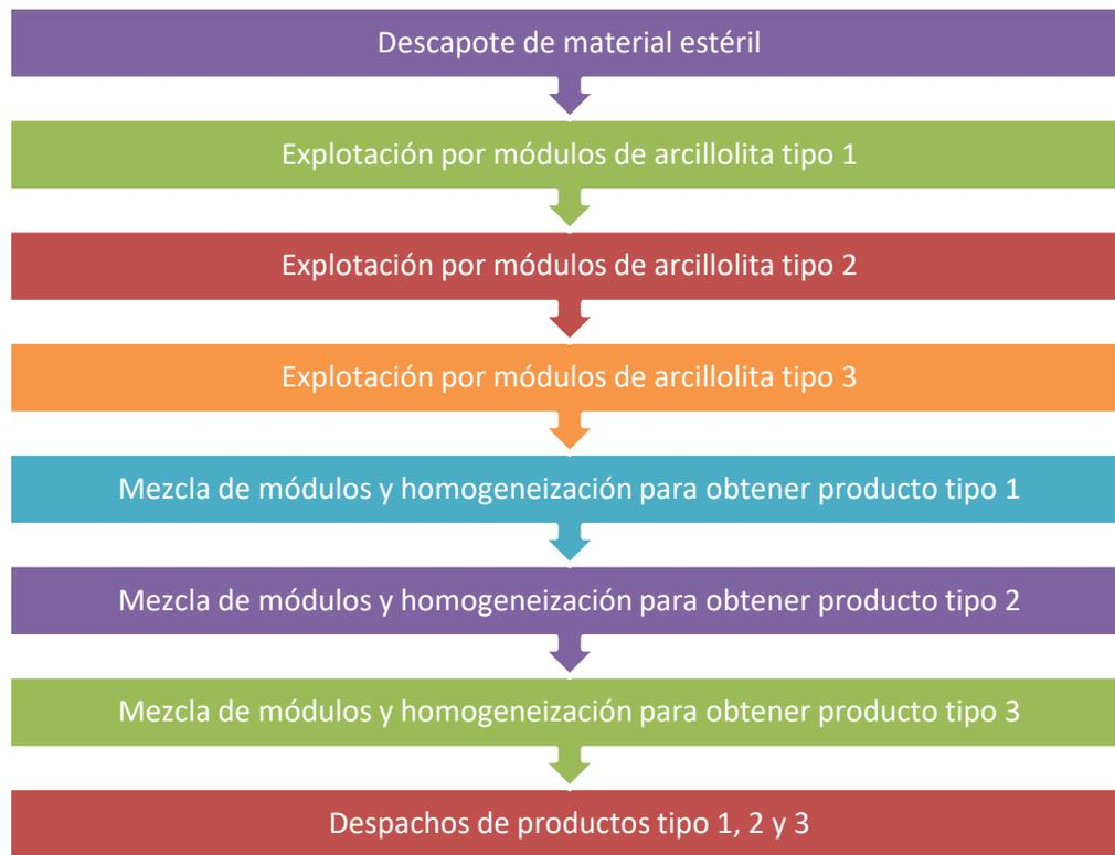
Figura 7. Proceso productivo de la mina a cielo abierto. Fuente: Organización Corona.
