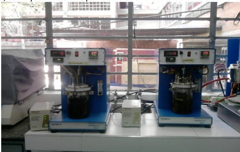
**Figura 2. Reactor de mezcla completa 1.5L**
