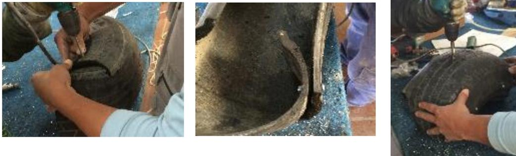
Figura 6.9. Proceso agujeros para unir paredes y para el drenaje del agua, Foto: Autor
