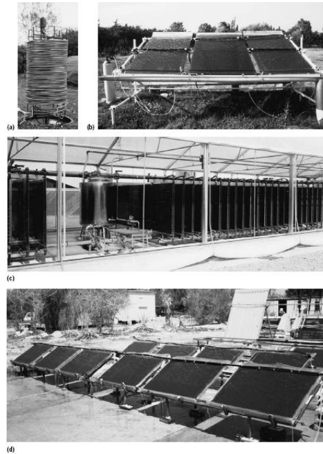
Figura 7: Bioespirales y Fotobioreactores planos. Flickinger 1999
