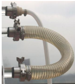
Figura 53: Manguera de alimentación de serpentín (superior) y manguera reforzada con alambre (inferior). Autor 2009.
