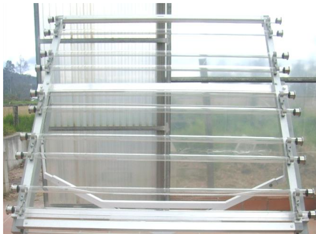
Figura 7. Tubería de vidrio montada en soportes
