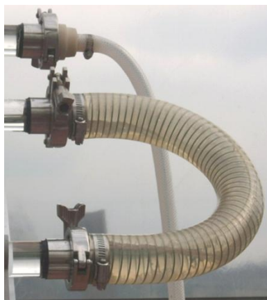
Figura 3. Manguera de alimentación de serpentín (arriba) y manguera reforzada con alambre (abajo)
