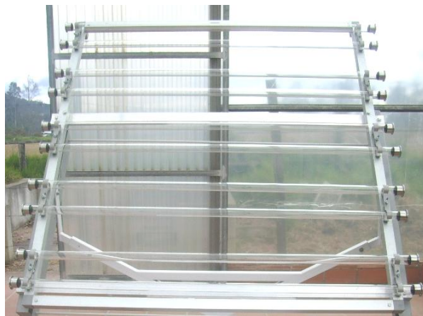
Figura 57: Tubería de vidrio montada en soportes. Autor 2009.
