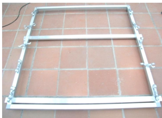
Figura 39: Soporte para fijación de la tubería de vidrio. Autor 2009.
