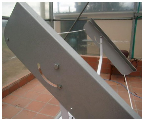
Figura 37: Travesaños laterales con las varillas de estabilización y ranuras de ajuste y graduación angular. Autor 2009.
