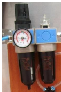
Figura 11. Unidad de mantenimiento
