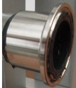
Figura 2. Bridas de unión hidráulica
