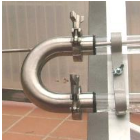
Figura 56: Codo de acero inoxidable apretado con abrazaderas de ajuste rápido. Autor 2009.
