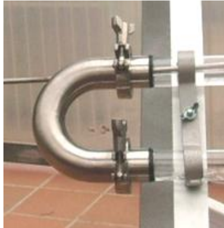
Figura 6. Codo de acero inoxidable apretado con abrazaderas de ajuste rápido.
