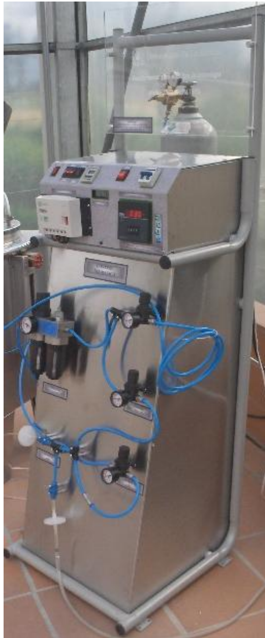
Figura 49: Control de presión de alimentación de la bomba. Autor 2009.
