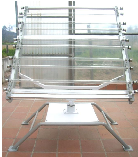
Figura 42: Tubería de vidrio instalada en estructura principal. Autor 2009.
