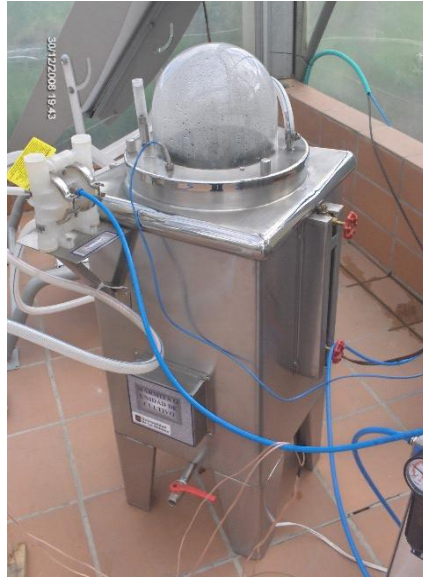
Figura 45: Marmita de almacenamiento con bomba neumática, tablero de control neumático, control de temperatura y Tanque de CO 2 . Autor 2009.
