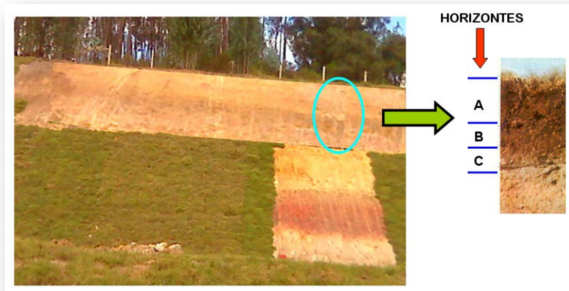
Figura 18. Horizontes del suelo. Fuente: Autor
