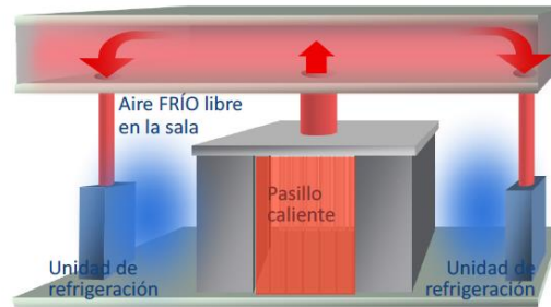
Figura 10. Contención de pasillos fríos 15 Figura 11. Contención de pasillos calientes 16
