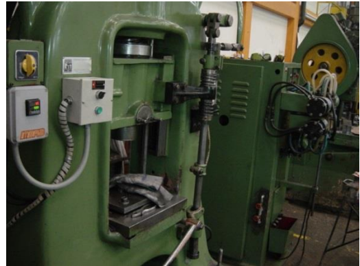
Imagen 40. Prensa de fricción y Calentadora Imagen 41. Contador instalado.
