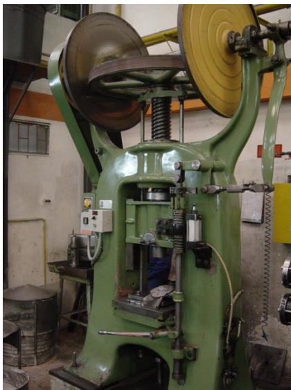
Imagen 38. Prensa de fricción GAMEI Imagen 39. Calentadora por inducción.
