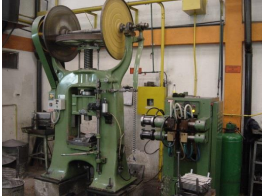
Imagen 40. Prensa de fricción y Calentadora Imagen 41. Contador instalado.
