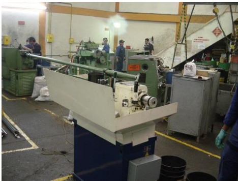
Imagen 46. Torno revolver AMA.
