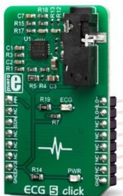
Figura 15. “Tarjeta de adquisición de señales cardiacas – ECG 5 Click” (MIKROE, 2022)
