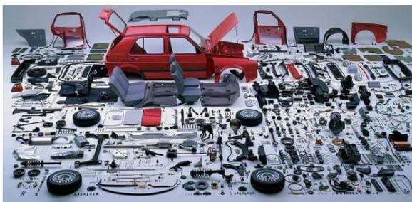
Ilustración 1 Despiece Vehículo. Fuente: [www.diariomotor.com](http://www.diariomotor.com)
