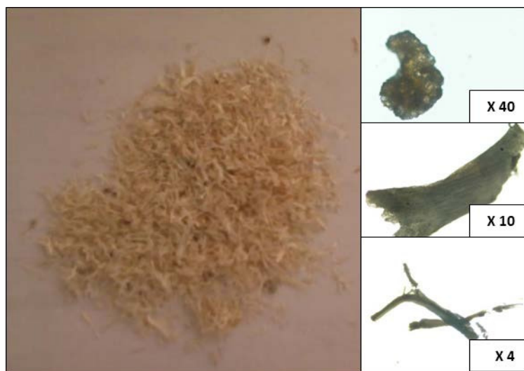
Figura 3. Aspecto físico de la Luffa Cylíndrica cortada con molino de cuchillas Ika Werke MF 10 basic
