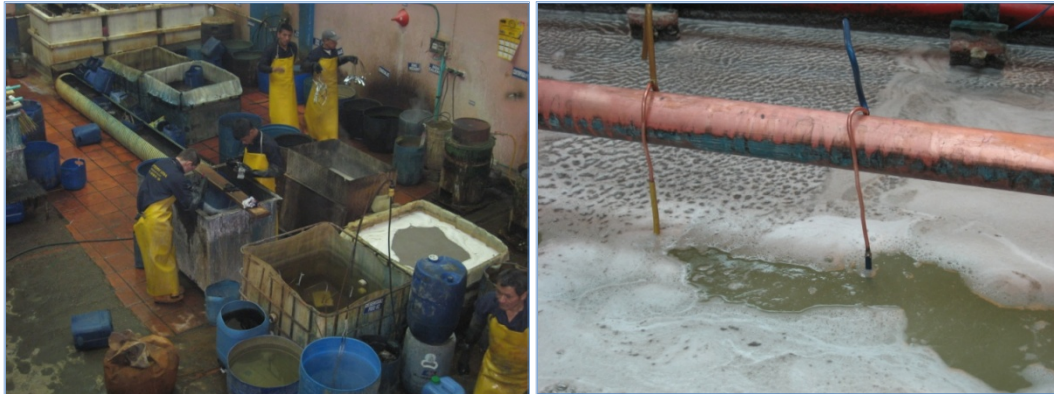
Figura 5. Sección de pretratamiento y lavado. Cobrizado alcalino cianurado.
