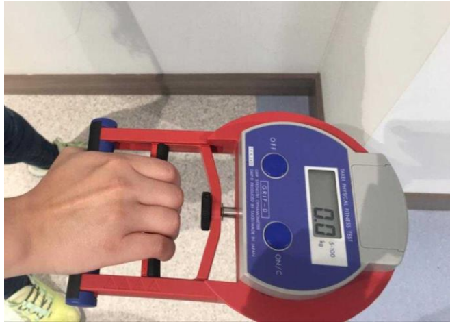
Imagen 2: Dinamómetro debidamente calibrado, al inicio de la prueba en 0.0 kg Fuente: propia
