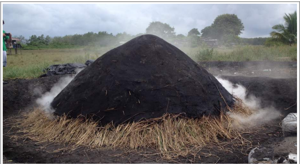
HORNO DE PRODUCCIÓN DE CARBÓN VEGETAL
