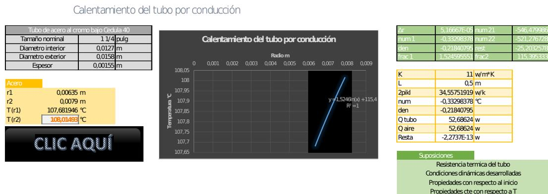
Figura B.2: Hoja de cálculo para el perfil radial de temperatura en el tubo de cobre
