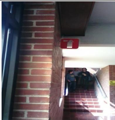
Esta zona destinada para los Sistemas de Servicios, de Evacuación y de Emergencia, cumple con la señalización del equipamiento del gabinete contra incendios, sin embargo no cuenta con la presencia de la herramienta clave para atender un incendio, la cual corresponde al extintor.
